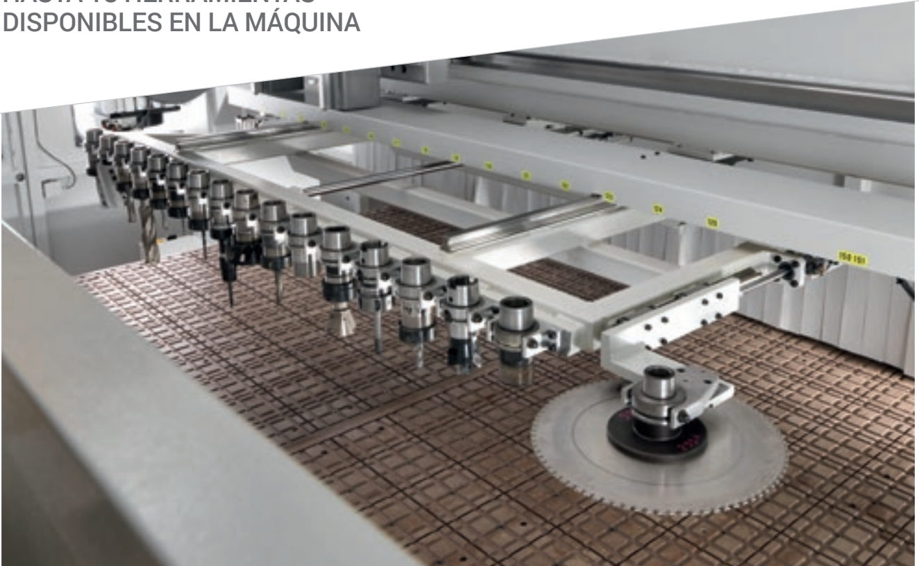
Almacén lineal de 17 posiciones para cambiar de herramienta de forma rápida.
